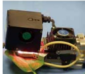
◆ 全自动叶室，具有 3 种可以更换的窗口，圆形（直径 1.8cm，面积 2.5cm<sup>2</sup>）、水稻叶片形（2.5×0.7cm，面积 1.7cm<sup>2</sup>）、阔叶形窗口（2.5×1.8cm，面积 4.5cm<sup>2</sup>）。适合测定不同形状和大小的叶片。
