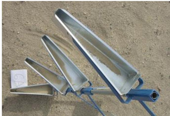
基本配置为 3 个 BSNE 风沙收集器安装在一个立杆上的不同高度，在一些研究中，取样器安装在 15 米高的位置。有些采样器已经在野外使用 10 多年了，但仍能达到满意的采样效果。
